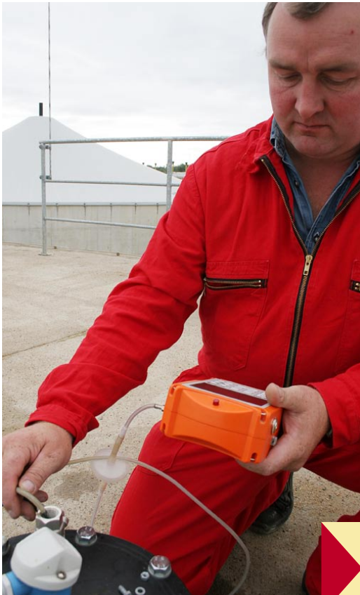
Ein mobiles Gas-Messgerät kann Leben retten. Es gehört zur Standardausrüstung.
