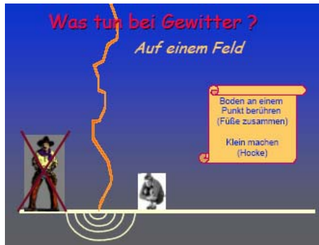
Potentialtrichter zur Erläuterung des Spannungsabfall und Stromfluß aus „Blitz und Donner“, Uni Kassel
