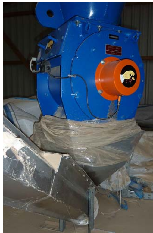
Foto: Funktionsrückmeldung Zellenradschleuse und fehlende Rückmeldung Förderschnecke
