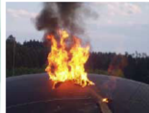
Bild 10 + 11: 6. Brandversuch ein brennender benzingetränkter Lappen wird auf den Foliengasspeicher geworfen
