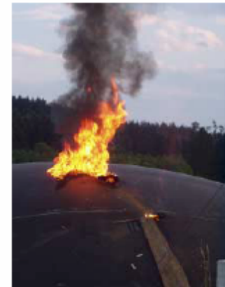
Bild 10 + 11: 6. Brandversuch ein brennender benzingetränkter Lappen wird auf den Foliengasspeicher geworfen
