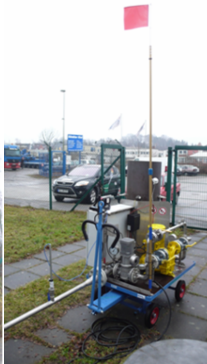
Abbildung 10: Schutzentgasung ohne thermische Beseitigung
