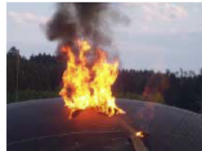
Bild 10 + 11: 6. Brandversuch ein brennender benzingertränkter Lappen wird auf den Folliengasspeicher geworfen
