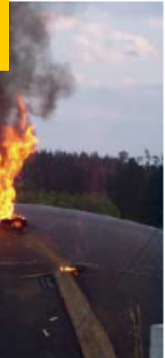
Bild 10 + 11: 6. Brandversuch ein brennender benzingertränkter Lappen wird auf den Folliengasspeicher geworfen
