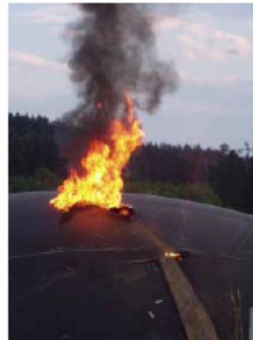
Bild 10 + 11: 6. Brandversuch ein brennender benzingetränkter Lappen wird auf den Foliengasspeicher geworfen
