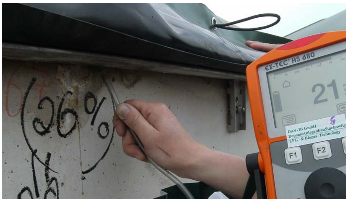
Abb. 2 Feststellung der Gaskonzentration mit einem geeigneten Meßgerät nach DVGW G 465-4
