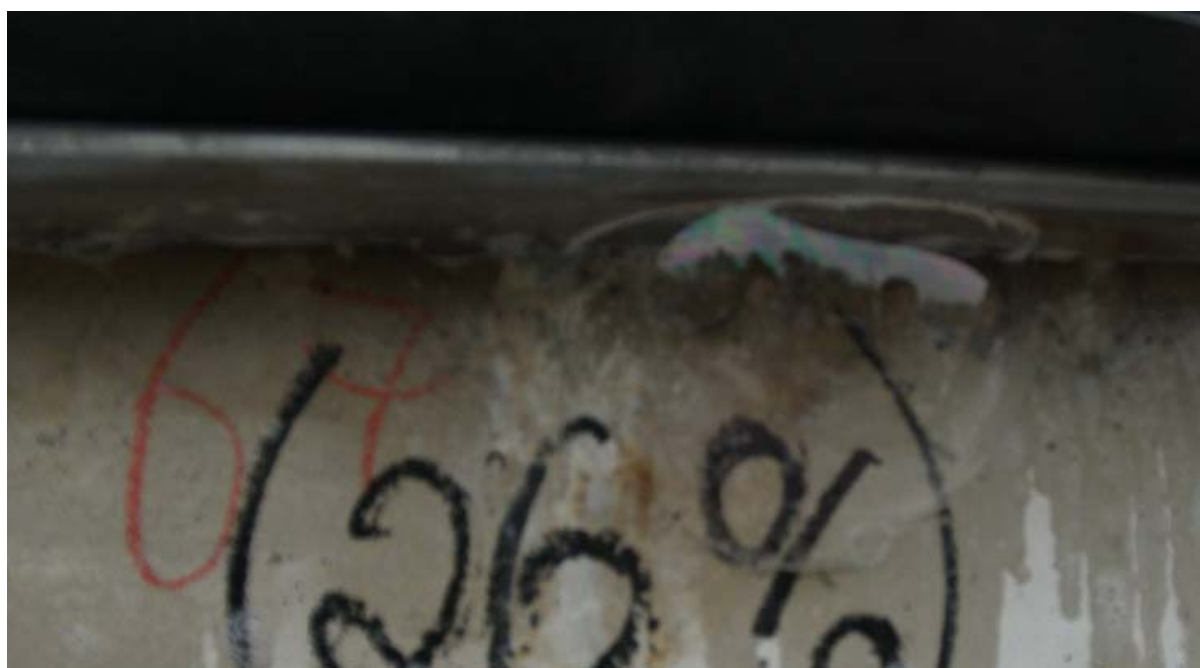
Abb. 3 Feststellung der Gasmenge – hier mit schaubildenden Mitteln nach DVGW G 469 A4. Dazu werden die Größe der Bläschen und die Anzahl der Bläschen pro Zeiteinheit ermittelt.
