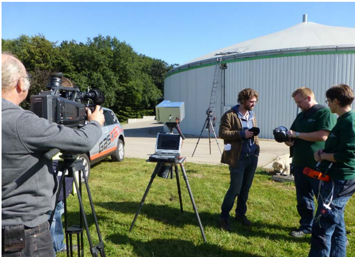
Abb. 1 GasCam und IR – Laser im Einsatz zum Nachweis von Methan - Leckagen / Undichtigkeiten.
