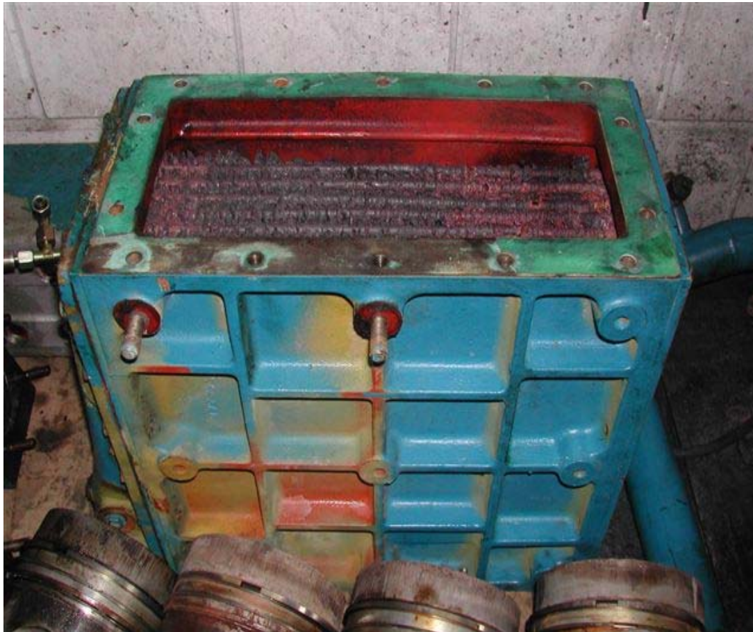
Wärmetauscher des Gasmotors
